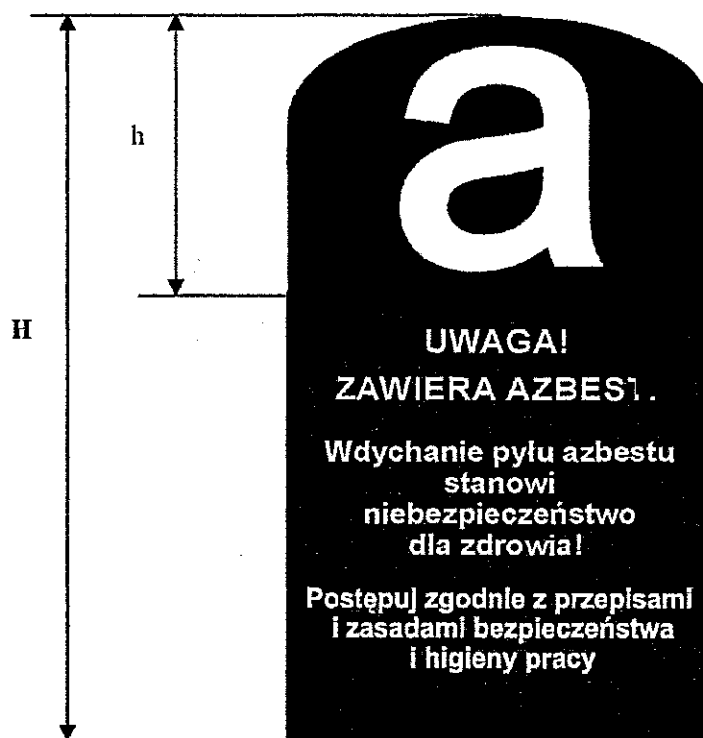
WZÓR OZNAKOWANIA INSTALACJI LUB URZĄDZEŃ ZAWIERAJĄCYCH AZBEST ORAZ RUR AZBESTOWO-CEMENTOWYCH Pomieszczenie zawiera azbest*
