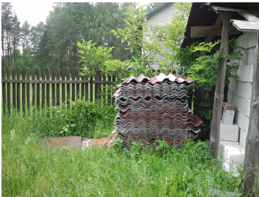
Rys. 2. Płyty azbestowe faliste złożone na palecie
